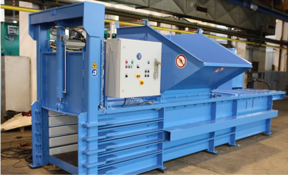
La presse à porte PAC est une presse horizontale à ligaturage manuel. Avec une force de compression de 50 t, la compression contre une porte permet de créer des balles de forte densité, même pour des matières difficiles. Les balles ont une section de 75 x 110 cm pour une longueur d'environ 1,2 m. Elles sont donc directement transportable vers les filières de recyclage.
