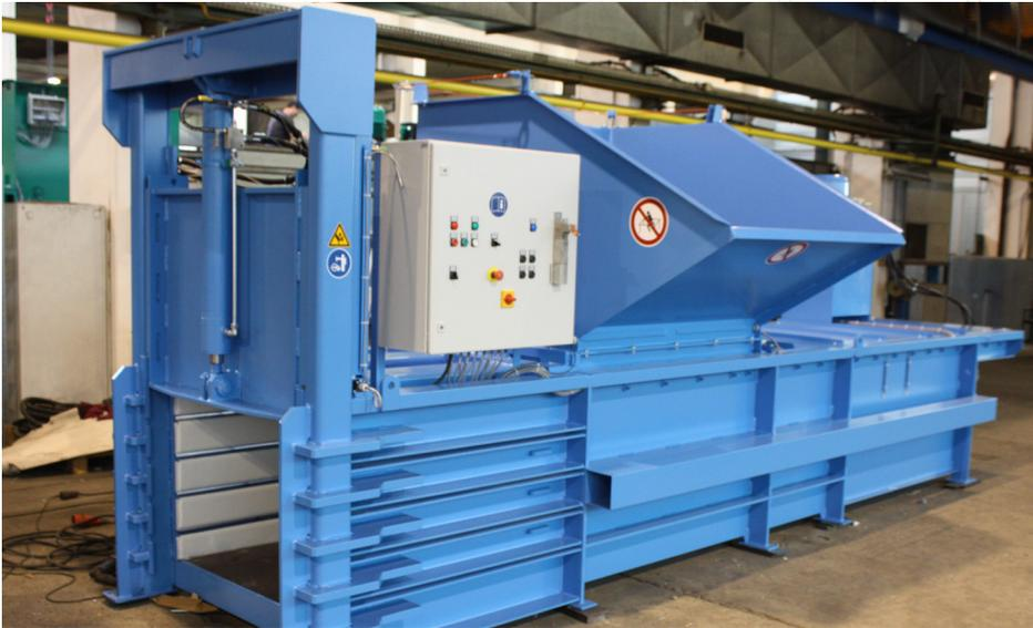
La prensa PAC, dotada de una puerta de guillotina vertical, está diseñada para elaborar balas y atarlas manualmente con alambres horizontales.
