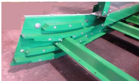
Guías de cadena atornilladas e intercambiables,
