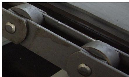
Cadena más resistente, con punto de ruptura de hasta 140 kN por tramo de cadena,
