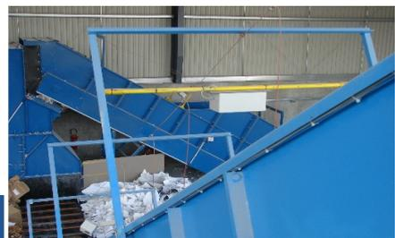
Sistema de protección personal y parada de emergencia de cable en lo alto del tramo ascendente,
