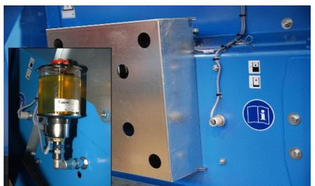
Lubricación automática de la cadena mediante engrasador por goteo con válvula magnética
