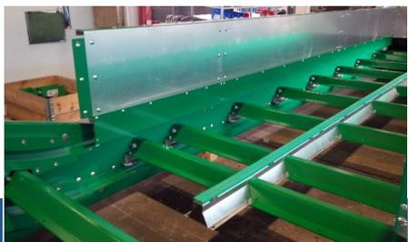
Soportes de deslizamiento adicionales en la sección del tramo horizontal con el fin de absorber fuertes impactos,
