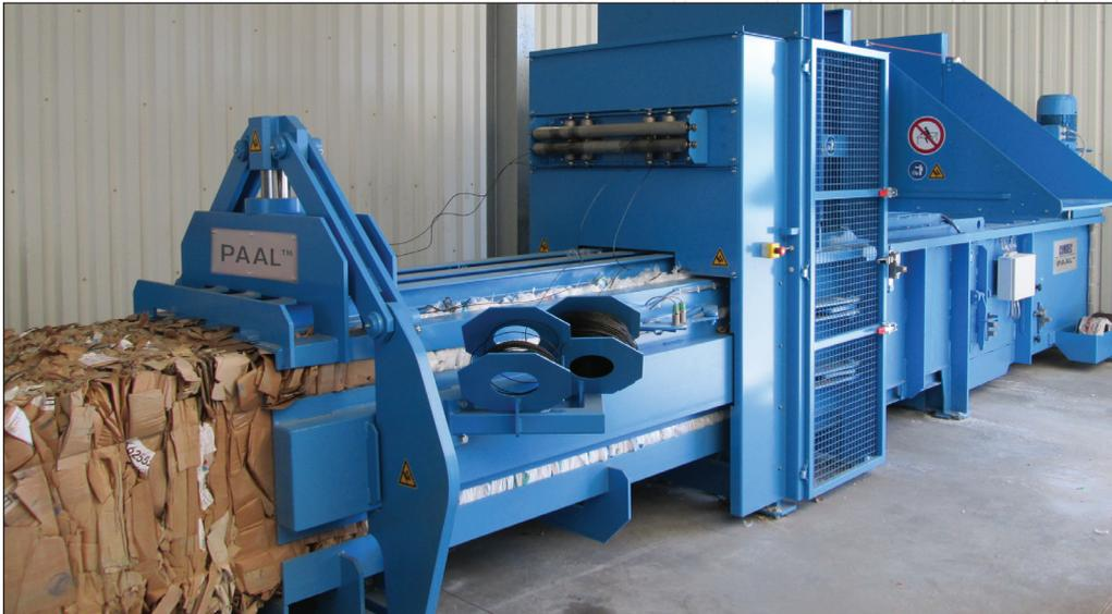
Die PACOMAT V-Kanalballenpresse von Kadant PAAL mit vertikalem Drahtbindesystem ist ideal für verschiedene Qualitäten von Altpapier, Pappe, Kartons, Folien und vielen anderen Materialien. Diese Kanalballenpresse ist robust und vollautomatisch, was sie zu einer wirtschaftlichen Ballenpresse macht.
