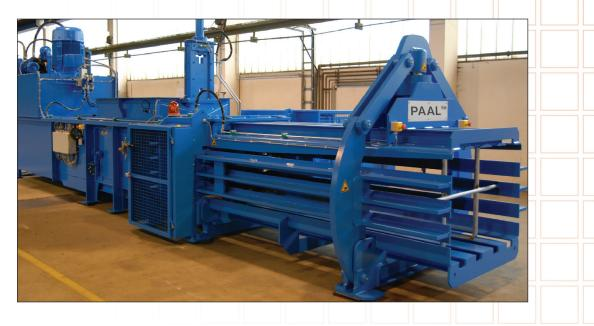
Die PACOMAT III-Kanalballenpresse von Kadant PAAL mit vertikalem Drahtbindesystem ist ideal für verschiedene Qualitäten von Altpapier, Pappe, Kartons, Folien und vielen anderen Materialien. Diese Kanalballenpresse ist robust und vollautomatisch, was sie zu einer wirtschaftlichen Ballenpresse macht.
