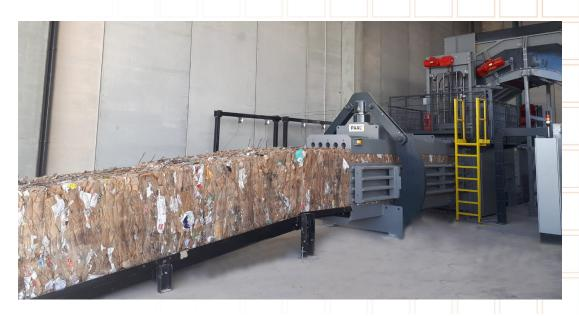
Die automatische Kanalballenpresse KONTI von Kadant PAAL steht für bewährte Spitzenqualität. Die KONTI Ballenpresse bietet im Dauerbetrieb hohes Belastungsniveau bei maximaler Wirksamkeit. Die robuste Konstruktion und die hohen Presskräfte von 120 bis 200 Tonnen bieten zuverlässige Funktionsfähigkeit.
