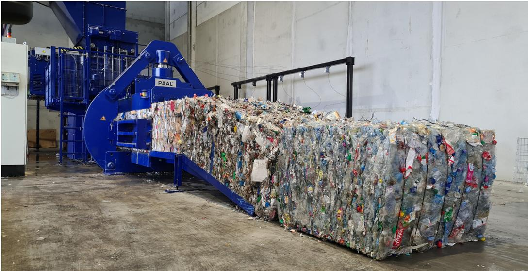
Die automatische Kanalballenpresse KONTI von Kadant PAAL steht für bewährte Spitzenqualität. Die KONTI Ballenpresse bietet im Dauerbetrieb hohes Belastungsniveau bei maximaler Wirksamkeit. Die robuste Konstruktion und die hohen Presskräfte von 80 bis 120 Tonnen bieten zuverlässige Funktionsfähigkeit.
