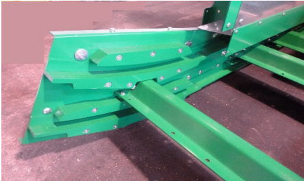
auswechselbare, geschraubte Kettenlaufschienen,
