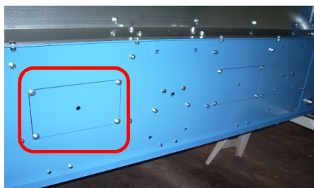
viele Wartungsöffnungen in der komplett geschraubten, schweren Stahlblechkantkonstruktion,
