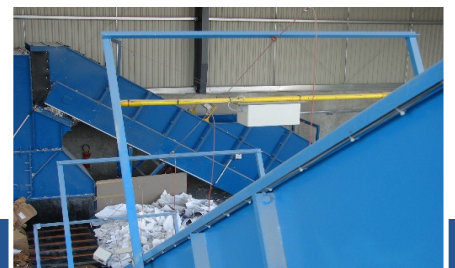
Personenschutzsystem und Seilzug Not-Aus oberhalb vom Steigteil,
