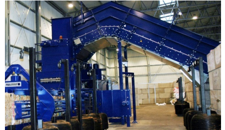
erhöhte Seitenwangen im Horizontal- und Steigteil - siehe auch den serienmäßig, stark abfallenden Abwurfkopf,
