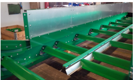
zusätzl. Gleitführung im Horizontalteil fängt schwere Stöße ab,
