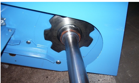
extra große Kettenräder sorgen für ruhigen Lauf des Kettengurtes,
