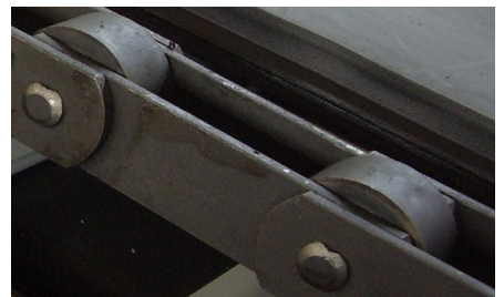
optionale Förderketten mit einer Bruchkraft bis zu 140 kN je Kettenstrang,
