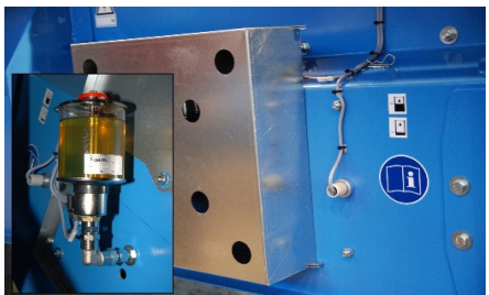
Olbehälter mit Magnetventil für automatische Steuerung der Kettenschmierung,
