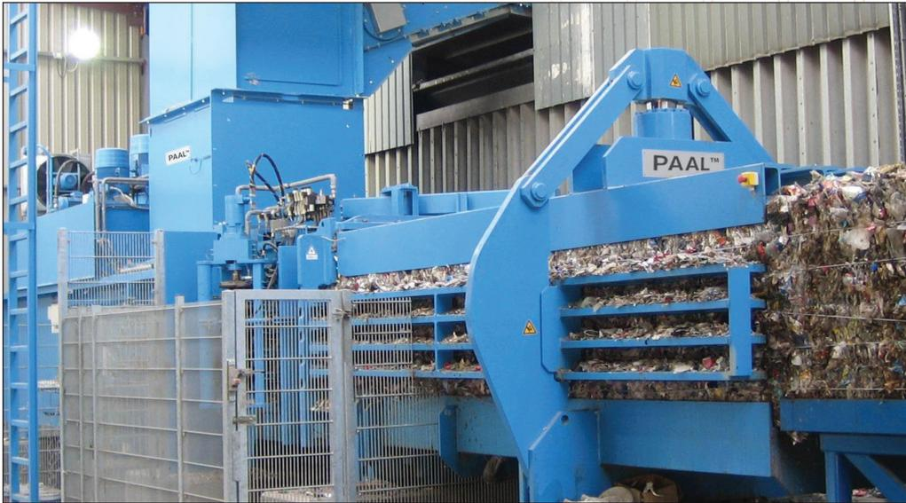
Das einzigartige Design der vollautomatischen DOKON Kanalballenpresse von Kadant PAAL macht sie zu einer leistungsstarken, effizienten Ballenpresse mit horizontaler Garn-Abbindung. Die DOKON bietet Presskräfte von 80 bis 200 Tonnen und Ballenformate von 800 x 1100 mm oder 1100 x 1100 mm x einstellbare Länge. Die Kombination aus hoher Presskraft, unabhängigem Schneid- und Verdichtungsvorgang sowie individuelle Einstellung der Kanalverstellung führt zu hochwertigen, schweren Ballen.
